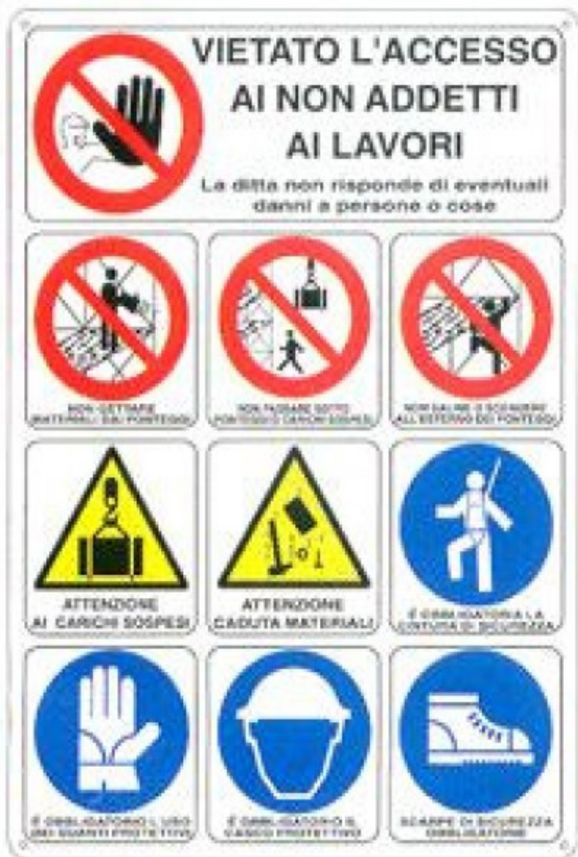
Fig. 2.2.1 - esempio di cartello di cantiere con segnaletica di sicurezza
